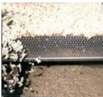
**Лента из пластикоткани.** Лента из пластикоткани особенно подходит для очень мелкозернистых и запыленных материалов. Особенный узор ленты сприяет хорошей воздухопроницаемости и предотвращает однако одновременно провал продукта также при очень мелком материале.
