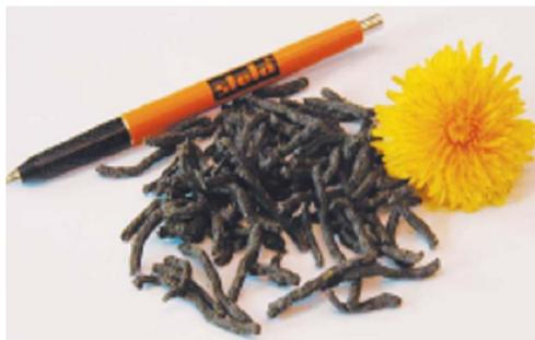
Комплекс предназначен для автоматической переработки озерного ила (сапропеля) путем формирования гранул из сырья влажностью текуче-вязкого состояния (54-81% в зависимости от содержания органики в общей массе и глинистых частиц).
